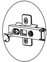
Scharniere von oben bis unten montieren
