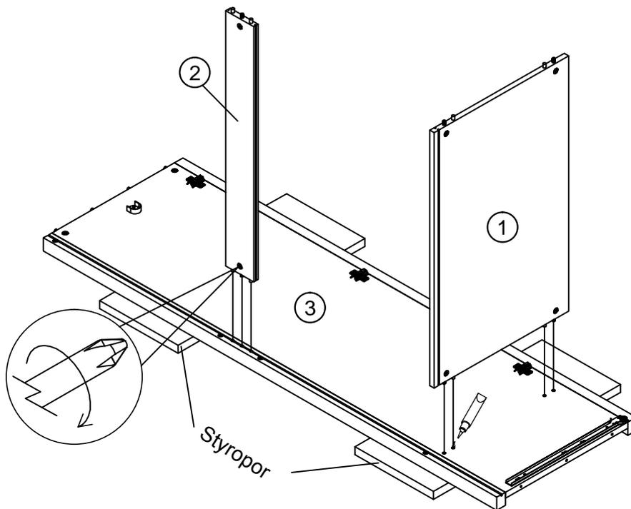
SCHIEBEN SIE DIE ZWEI TEILPLATTEN ZUSAMMEN UND RICHTEN SIE DABEI DAS BOHRLOCH MIT DEM DÜBEL AUS
