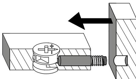
DREHEN SIE DIE EXZENTER-VERBINDER IM UHRZEIGERSINN
