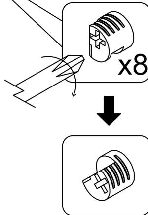
**UM EXZENTER-VERBINDUNG ZU LÖSEN**
