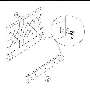
$A x 8^{\text{M8} \times 18 \text{mm}}$
